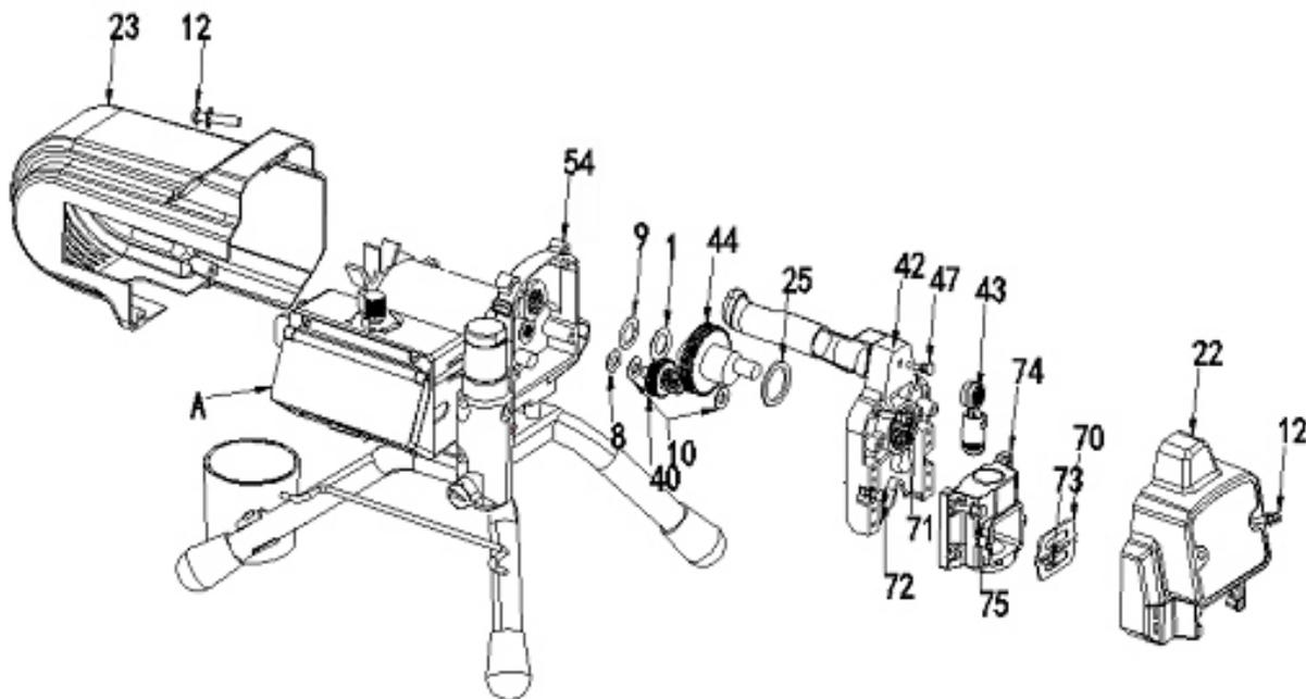
3. Снимите винты (73) и крышку штока насоса (70).
