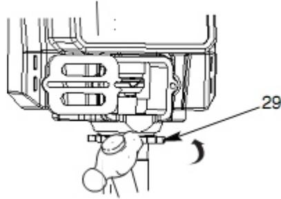
7. Поверните контргайку (29) против часовой стрелки до остановки. Затяните контргайку вручную, затем стукните молотком весом 20 унций с усилием 75 футов на фунт (102 Нм (максимум), чтобы повернуть гайку еще на 1/8 – 1/4 оборота.
