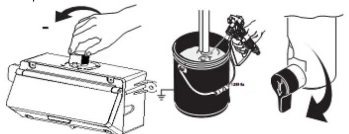
3. Активируйте предохранитель спускового крючка распылителя при отключении блока или если оставляете блок без присмотра.
