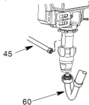
9. Заполняйте герметизирующую гайку TSL, пока жидкость не выступит поверх уплотнения.
